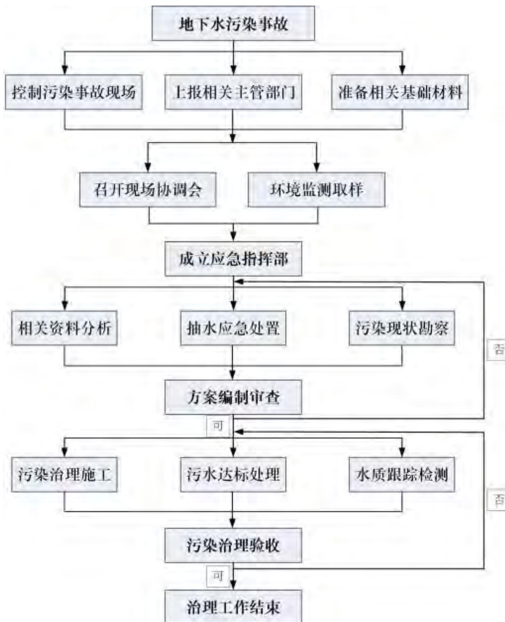
图 8.2-8 地下水污染应急治理程序框图
